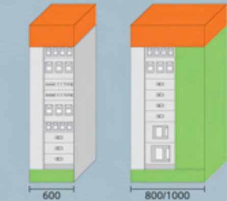
至160 A/ 馈电回路 至630 A/ 馈电回路
